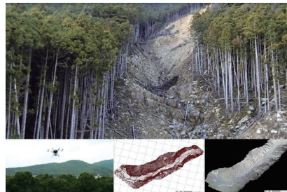
ICT活用技術イメージ例（UAV撮影動画及び画像を用いた図化と3次元データ取得）
