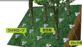
斜面安定工法(ノンフレーム工法)
