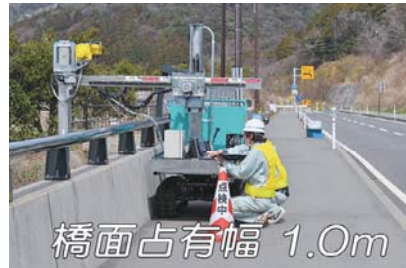
システム占有幅1.0mで通行車両への支障を回避できます。
