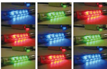
伸縮することによって光の色が変わる「光る変位計」
